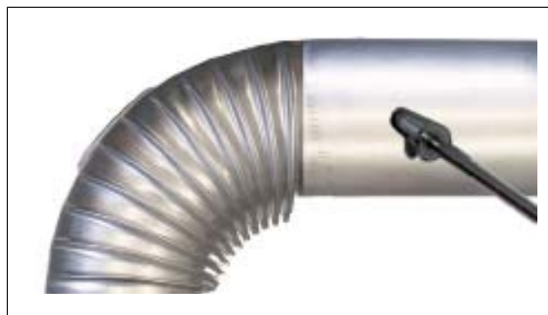
Рис: Измерение величины отходящих газов CGU-2(K)
