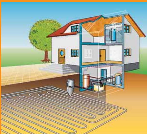
Схема с земляным плоским коллектором
