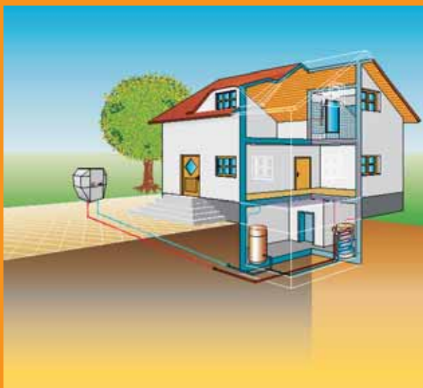
Вариант установки оборудования снаружи
