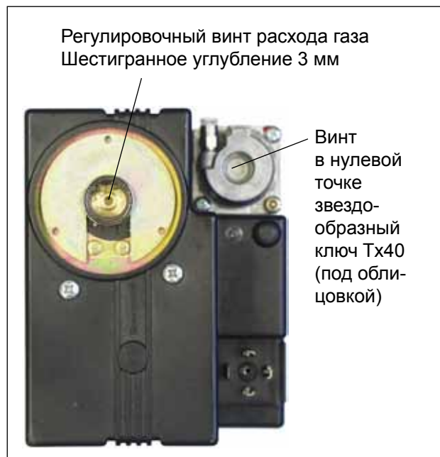
Рис.: Газовый комбинированный клапан
