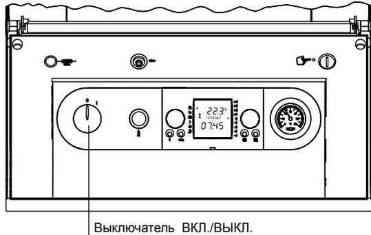
Если устройство регулирования включается с помощью выключателя, то управление системой отопления выполняется в соответствии с заводскими настройками.
