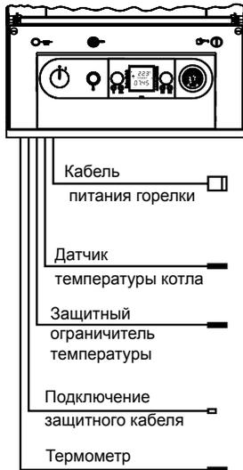
При монтаже устройства регулирования проследить за тем, чтобы не повредить капилляры датчиков!
