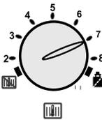
**Регулятор температуры воды в системе отопления**
