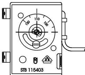
Защитный ограничитель температуры (STB) устанавливается на заводе на температуру 120°C.
